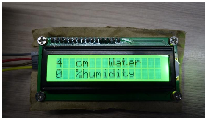
Рисунок 3.13 – Объект находится на расстоянии 4 см от робота, в контейнере присутствует вода и датчик не находится в почвы
