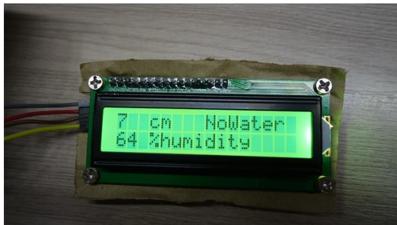
Рисунок 3.12 – Объект находится на расстоянии 7 см от робота, в контейнере отсутствует вода и процент влажности в цветке – 64%
