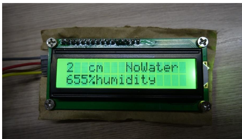
Рисунок 3.15 – Объект находится на расстоянии 2 см от робота, в контейнере отсутствует вода и датчик влажности почвы помещен в воду
