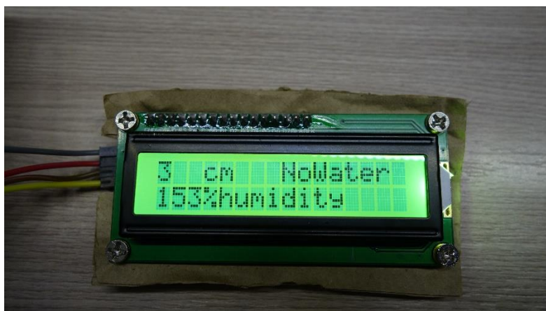
Рисунок 3.14 – Объект находится на расстоянии 3 см от робота, в контейнере отсутствует вода и процент влажности в цветке – 153%
